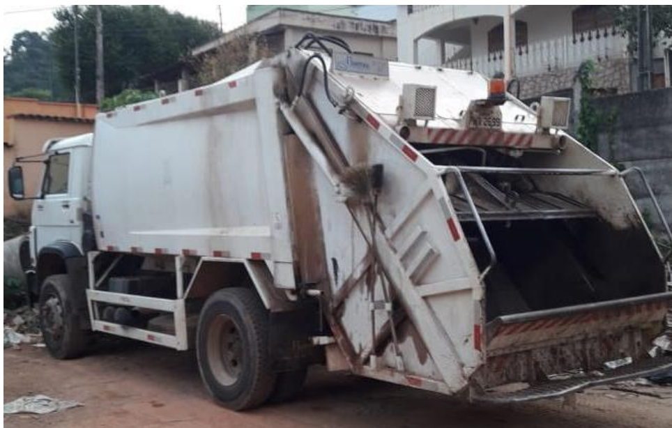
Figura 158 - Caminhão compactador empregado na coleta de resíduos sólidos
